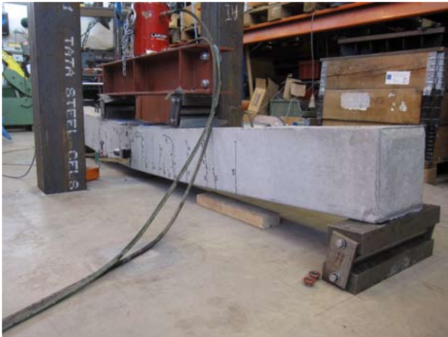
Provning av betongbalk vid KTH Betongbyggnad.
